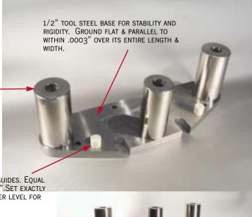
HARD CERAMIC HEIGHTING GUIDES. EQUAL IN HEIGHT TO WITHIN .0002".SET EXACTLY AT THE RECOMMENDED LOWER LEVEL FOR ALL ROLLING GUIDES.
